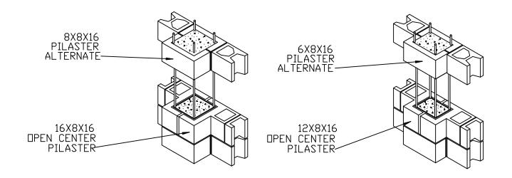
16"X16" □PEN CENTER 4-# BARS MINIMUM TIES AS REQUIRED 12"X16" □PEN CENTER 4-# BARS MINIMUM TIES AS REQUIRED
